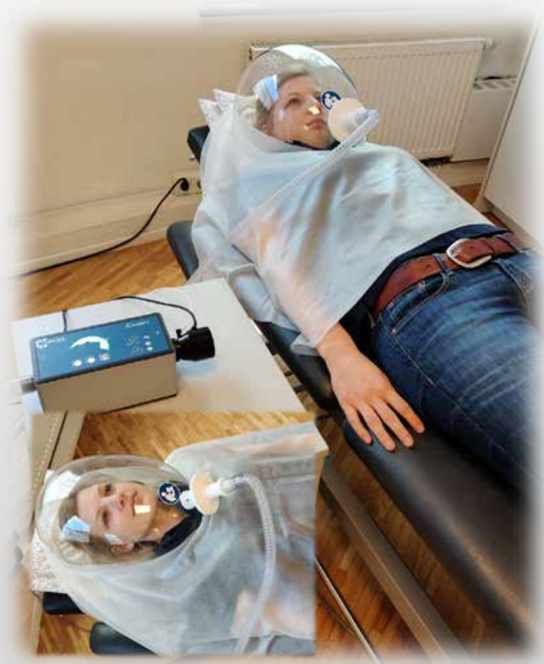
Ruheumsatzmessung über Canopy-Option an Cortex Biophysik Metalyzer 3B
